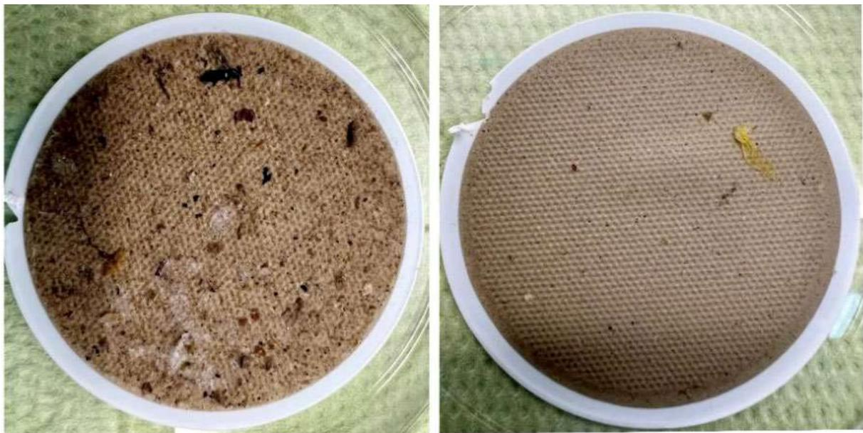
**Abbildung II.6: Abwasserprobe über Membranfilter filtriert, links Homogenisiert durch Schütteln, rechts abgesetzt**
